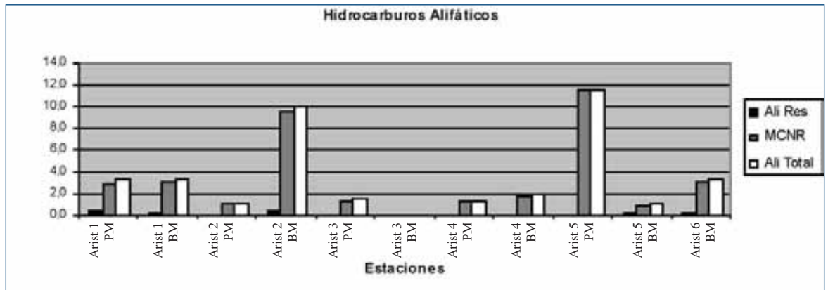
Figura 2. Hidrocarburos alifáticos en los sedimentos de las estaciones: Ali Res, alifáticos resueltos; MCNR, mezcla compleja no resuelta; Ali Total, alifáticos totales.
